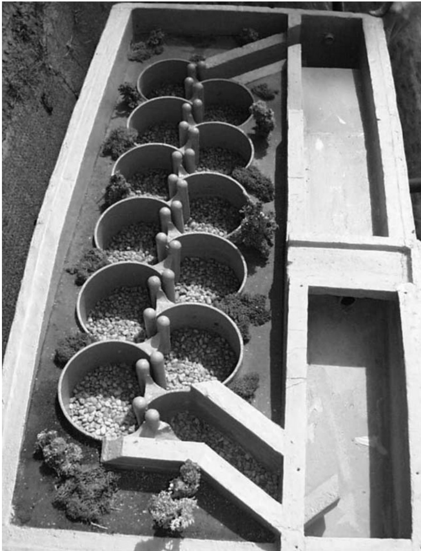
Bild 1: Prototyp des Mäander-Fischpasses im Modell, Typ A
