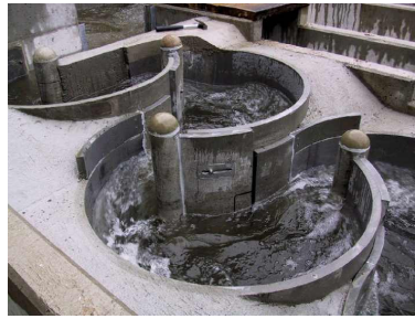
Bild 3: Strömungsbildung im Mäander-Fischpass, Hydrolabor Schleusingen der Uni Weimar
